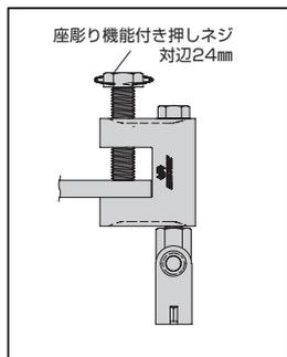
②座彫り機能付き押しネジで締め付ける。
