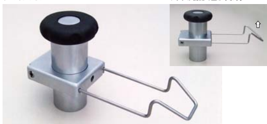
① 左右のフック止めネジを緩めフックをドアに合わせ不要部 (斜線部) を計測。 ② ドアのない状態でフックをホルダー方向へ押し不要部分を切断する。 ③ フックを所定の位置に戻し左右のフック止めネジを締め付け完了。 フック切断部がピンの外周より出ている場合はフックが下方へ移動しなくなります。
