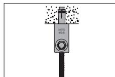
③ブレース材固定用ボルトを締め付ける。
