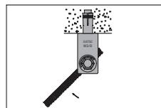
④吊りボルトの角度調整後に固定用ナットを締め付ける。
