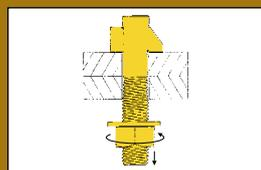
手前に引き込みナットを締め付ける
