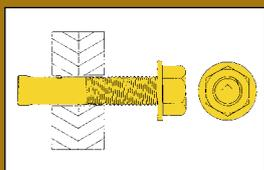
被締結物と締結物に下穴を明け、矢印を上に向けて下穴に入れる
