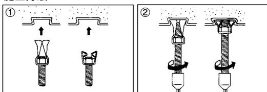
吊りボルトにハンガーを組付け後、デッキプレートに押し当て締付けるだけで取付け完了です。
